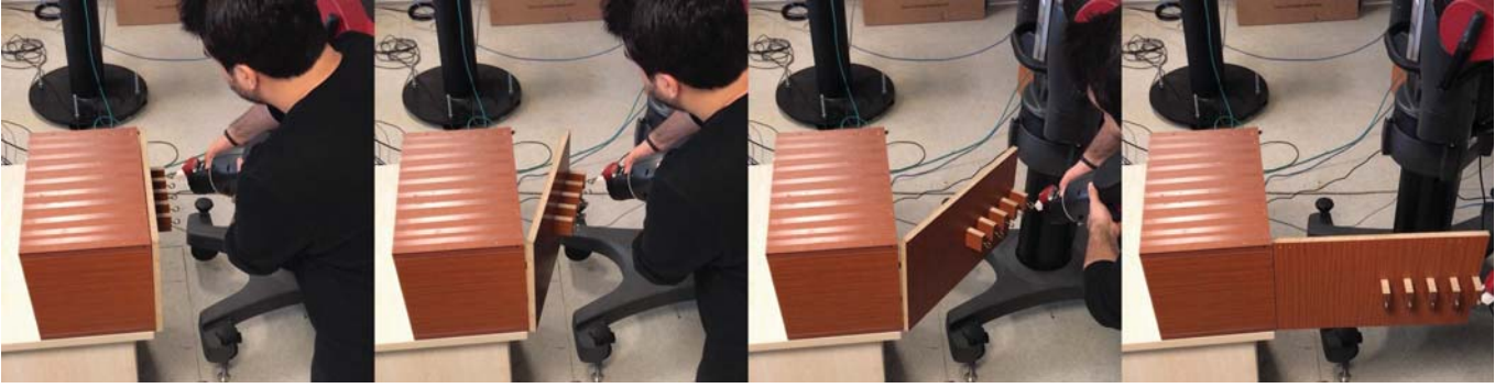
Şekil 5: Kinestetik yolla 1. kulpla dolap kapağı açma gösterimi. Aynı gösterimler ortadaki yörüngesi tahmin edilmek istenen 3.kulp dışında 2., 4. ve 5. kulplardan da alınmıştır.
