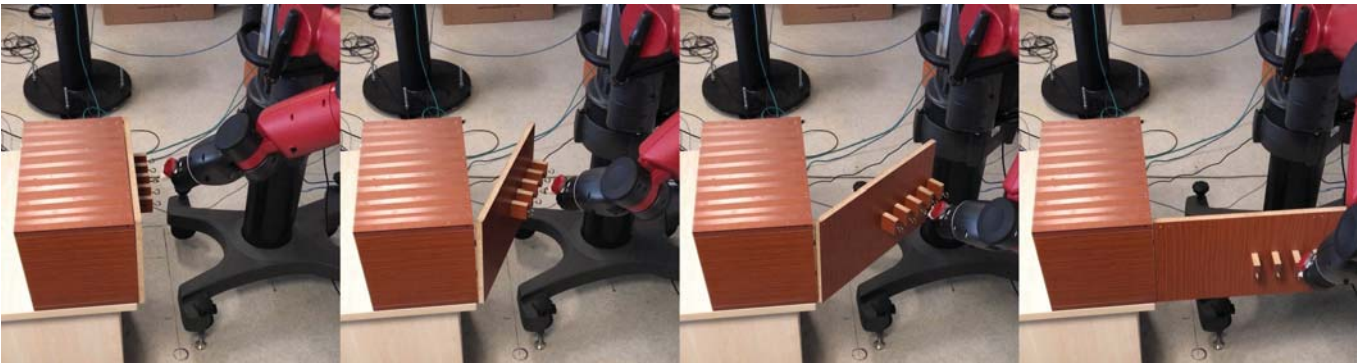
Şekil 7: PDMP ile öğrenilen modele 3. kulbun ilk konumu parametre olarak verilerek üretilen yörüngenin Baxter robot tarafından uygulanması. Video linki : https://youtu.be/GD1WFIIBCsa
