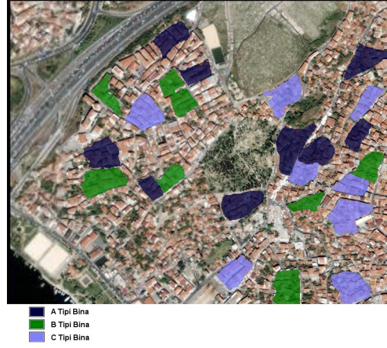
Şekil 4: Örnek bir bölge için maskelerin A, B ve C tipi olarak gruplandırılması.
